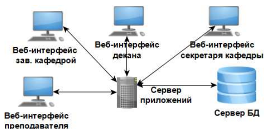
Рис. 3. Архитектура проектируемой подсистемы
