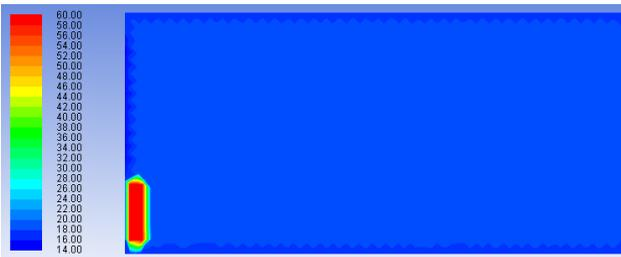
Рис. 4. Распределение температуры при нагреве от батареи с учетом движения воздуха
