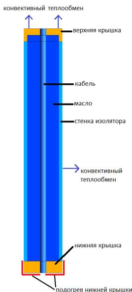
Рис. 1. Схема расчета температурного поля концевой муфты
