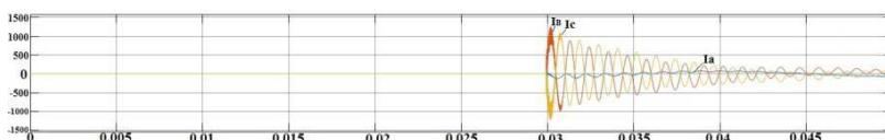
Рис. 3. Неуправляемое включение конденсаторной батареи
