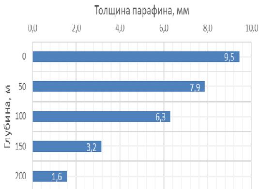
Рис. 4. Распределение жидкой и твердой фаз в НКТ
