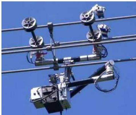
Рис. 4. Колёсный робот для диагностики ЛЭП Expliner
