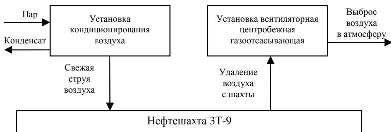
Рис. 1. Упрощенная структурная схема вентиляции уклонного блока нефтешахты 3Т-9
