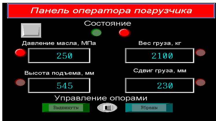
Рис. 2. Вид рабочей программы при превышении параметра «Давление масла»
