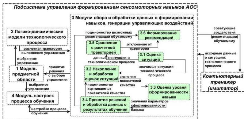
Рис. 2. Схема системы автоматизированного управления
