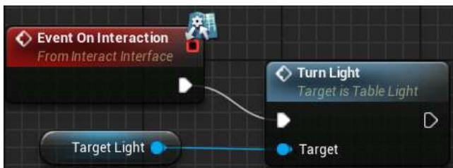
Рис. 5. Blueprint, описывающий кнопку для включения лампы
