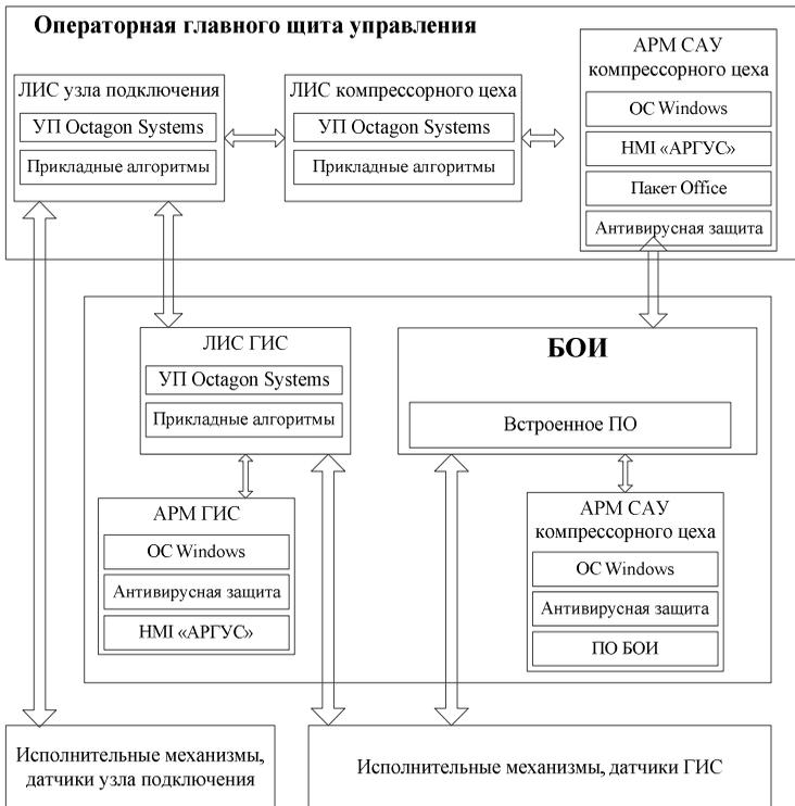
Рис. Схема программного обеспечения
