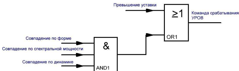
Рис. 2. Логика работы адаптивной части УРОВ
