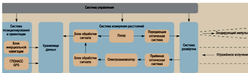
Рис. 1. Компоненты системы LIDAR
