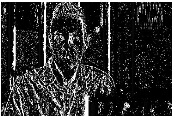
Рис. 3. Изображение с закодированной маркой, подвергнутое преобразованию Хаара
