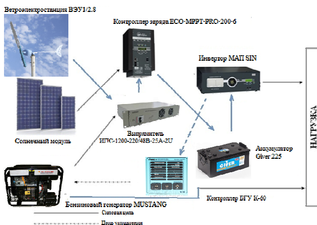
Рис. 3. Схема автономной системы энергоснабжения
