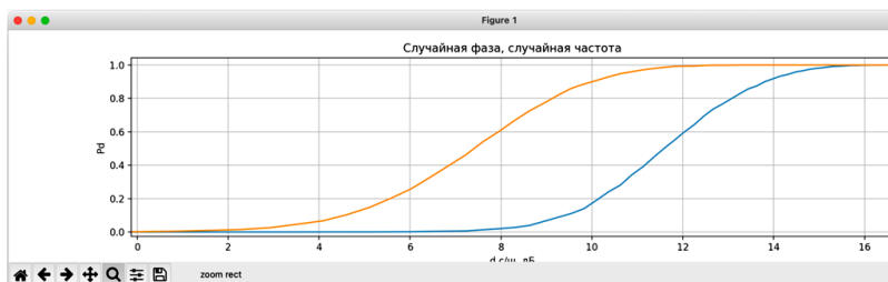
Рис. 4. Кривые характеристик обнаружения исследуемого сигнала при 32-точечном БПФ
