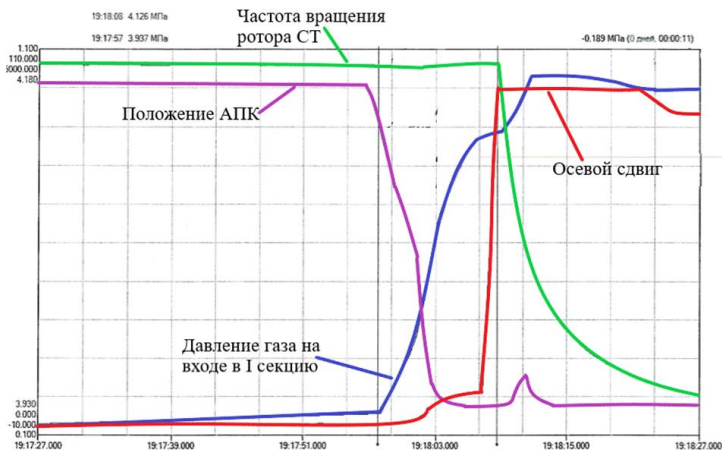
Рис. 3. График трендов с давлением на входе в первой секции агрегата
