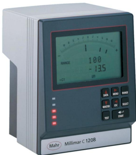
Рис. 1. Прибор показывающий малогабаритный Millimar C 1208 M
