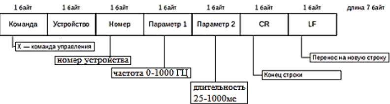
Рис. 4. Структура формата команды управления с двумя параметрами
