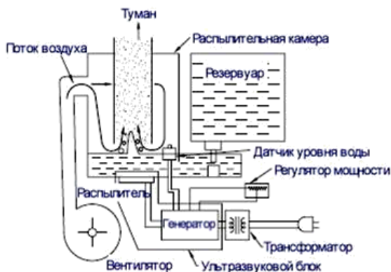
Рис. Устройство ультразвукового увлажнителя
