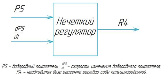
Рис. 3. Структура нечеткого регулятора по управлению раствором соды
