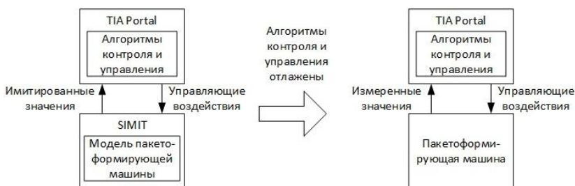
Рис. 5. Отладка алгоритмов контроля и управления
