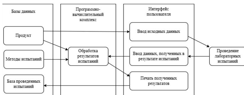
Рис. 1. Схема информационных систем для лабораторных испытаний
