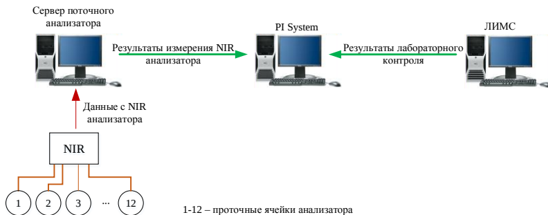
Рис. 1. Структурная схема информационного обмена до внедрения веб-интерфейса
