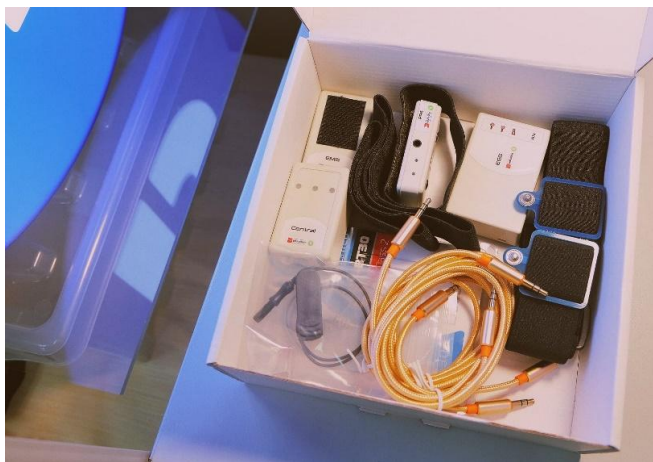
Рис. 1. Базовый учебно-проектный набор для работы с широким спектром сенсоров на базе платформы LEGO MINDSTORMS Education EV3
