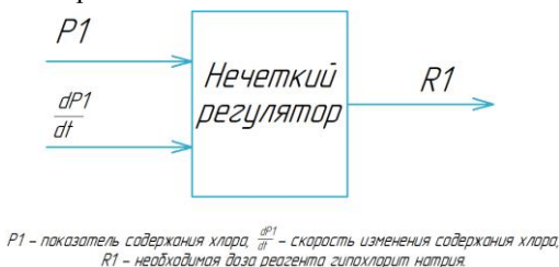
Рис. 2. Структура нечеткого регулятора по управлению гипохлоритом натрия
