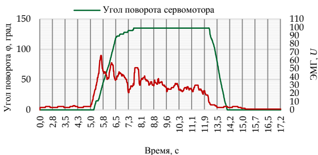
Рис. 4. График зависимости угла поворота сервомотора от сигнала ЭМГ
