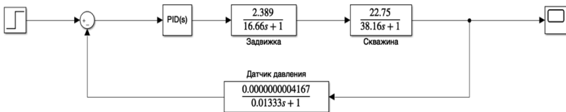
Рис. 6. Контур управления с ПИД-регулятором
