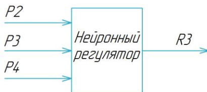
Рис. 1. Структура нейронного регулятора
