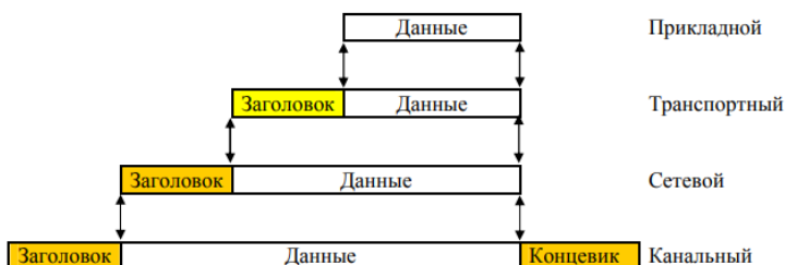
Рис. 1. Принцип инкапсуляции в стеке протоколов
