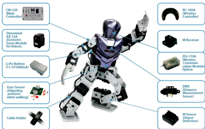
Рис. 1. Робототехнический комплекс с обозначением компонентов
