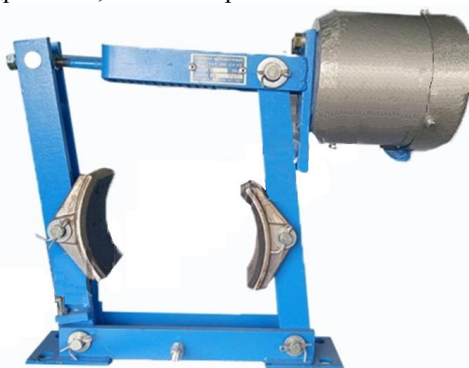
Рис. 3. Внешний вид тормоза с электромагнитом
