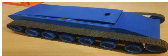
Рис. 1. Распечатанная подвижная платформа
