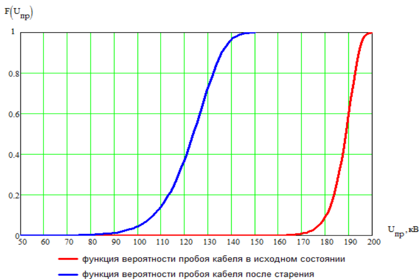
Рис. 1. Графики распределения функции вероятности пробоя кабеля до и после старения
