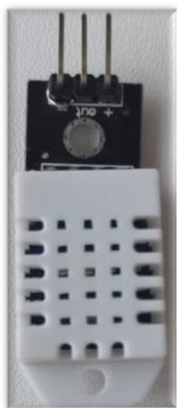
Рис. 3. Цифровой датчик DHT22
