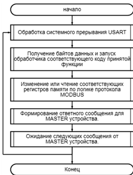
Рис. 4. Алгоритм работы режима SLAVE драйвера MODBUS
