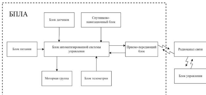
Рис. 1. Структурная схема квадрокоптера
