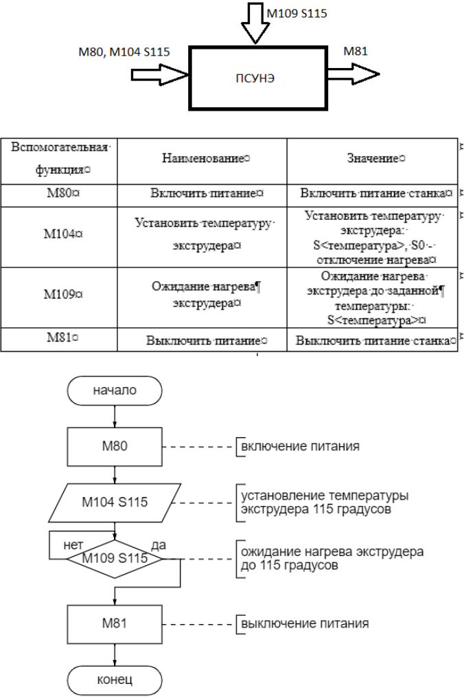
Рис. 4. Спецификация сигналов и алгоритм нагрева экструдера
