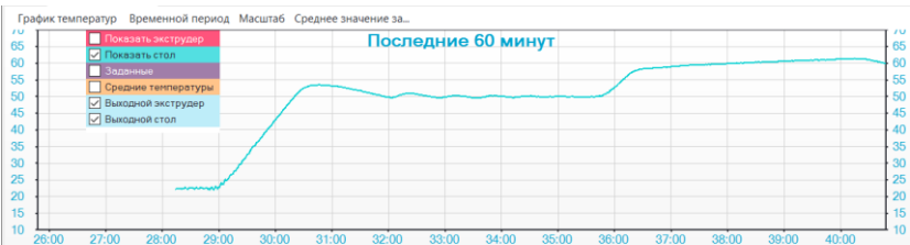
Рис. 3. График нагрева стола при исполнении алгоритма
