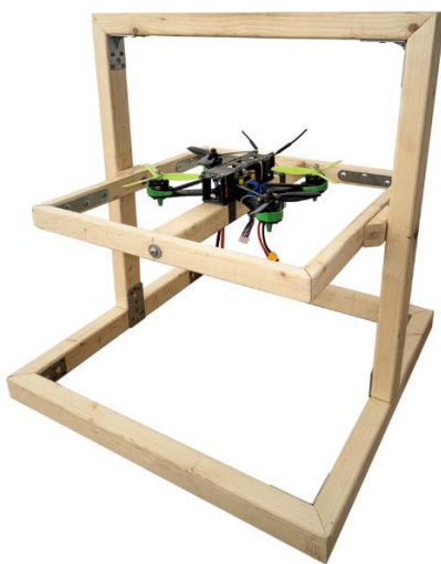
Рис. 3. Лабораторный стенд для исследования беспилотных летательных аппаратов
