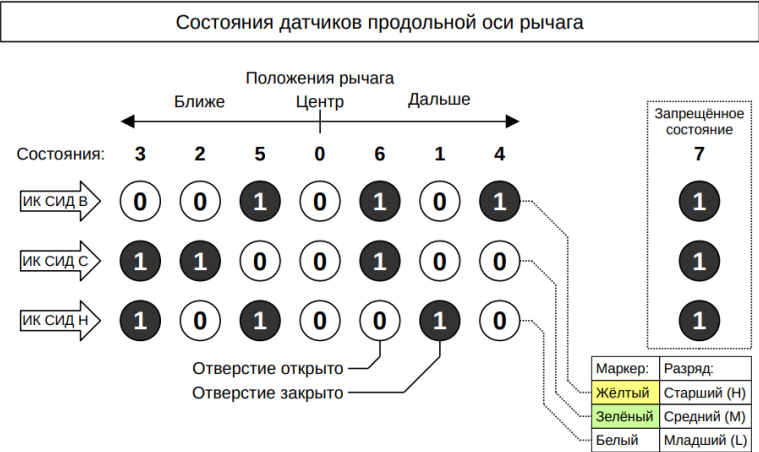
Рис. 6. Кодировка состояний для датчиков продольной оси рычага
